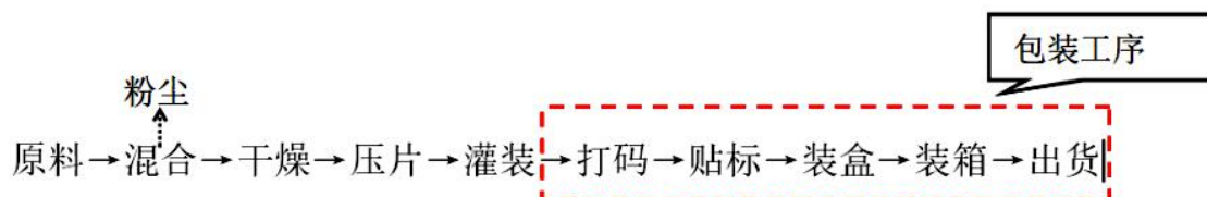
图 2-1 固态产品工艺流程图
